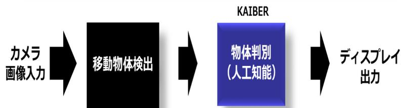
自動運転やロボットにおいては、カメラに映される膨大な量の時系列画像に対するリアルタイム（実時間）での精度の高い計測処理や、AI を用いた確度の高い画像認識処理が必要とされております。認識処理の高度化に伴って必要な計算量は数 TOPS(PC 数百台分)以上になります。しかし、冷却が困難で夏にはが高温になる車載システムやモバイル機器では 1W 以下という低消費電力が求められます。そこで、高速化と低消費電力化を両立させ、これらの機器に組み込み可能なディープラーニングシステムを開発しました。
